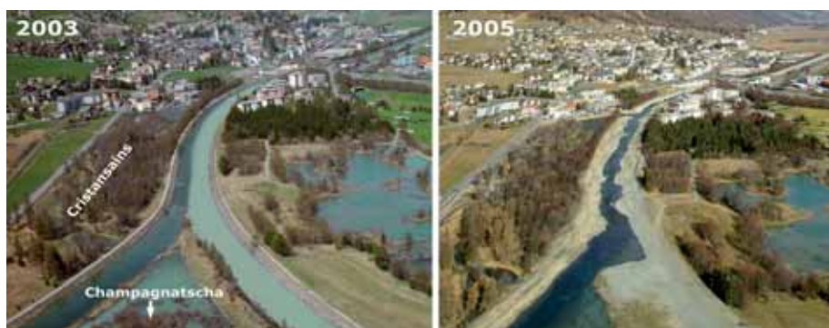
Bild 11. Zusammenfluss von Flaz vegl und En (Blick von Champagnatscha En-abwärts in nördlicher Richtung): Die auffälligste Veränderung im Bereich der alten Flazmündung ist die nun veränderte Wasserführung. Während 2003 En (von links) und der durch Gletschermilch getrübt Flaz (von rechts) noch weitgehend unvermischt durch Samedan flossen, enthält das nun restrukturierte En-Gerinne seit 2005 nur noch Wasser aus En und Flaz vegl.
