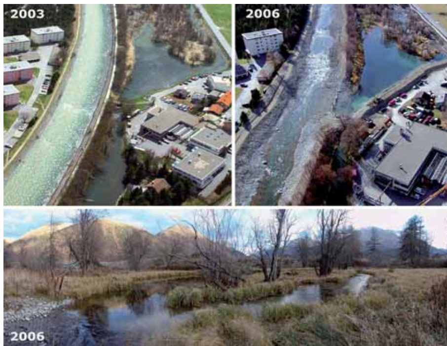
Bild 15. Die Aue Cristansains: Die bis 2005 vom En weitestgehend getrennte Aue Cristansains (oberes Bild) wurde wieder an vier Stellen an das System angebunden. Die Aue besitzt nun einen permanenten Durchfluss und ist oben wie unten niveaugleich mit dem En verbunden. Daneben kann sie mittels zweier weiterer Senkmulden im En-Damm periodisch überflutet werden.
